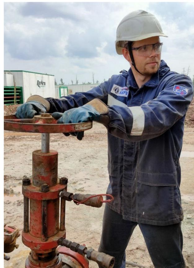
Проверка работы противовыбросового оборудования
